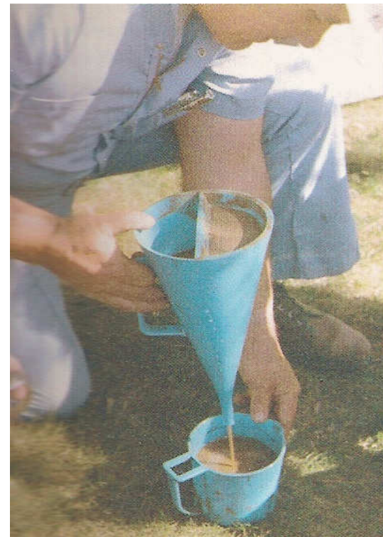
Medición de la Viscosidad del Lodo
